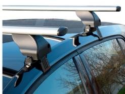
**VÉHICULE SANS SYSTÈME D'ACCROCHE :** on y installe des barres dont le pied vient s'accrocher dans l'entrebâillement de la portière.
