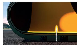
Une doublure interne du pneu, située dans la zone de la couronne colmate automatiquement une crevaison jusqu'à 5 mm de diamètre dans la zone de la bande de roulement.
