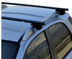
**VÉHICULE AVEC BARRES LONGITUDINALES D'ORIGINE,** intégrées ou non au pavillon du véhicule : on y installe des barres de toit dites « railing ».
